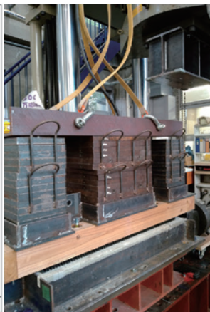
図7 RC基礎と木製土台の間に、摩擦アイソレータを挟んだ1質点系振動実験装置
